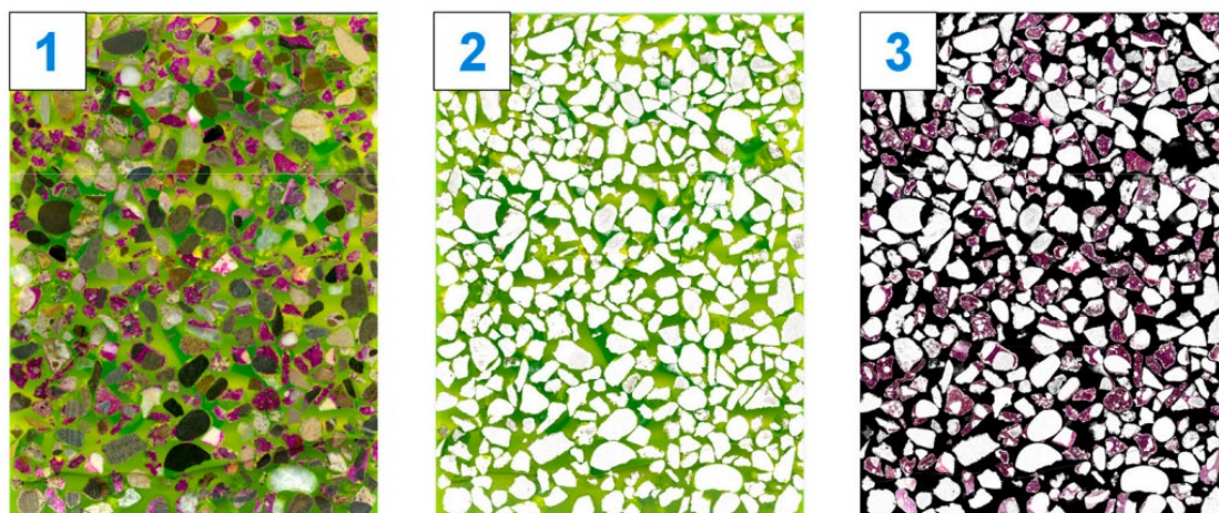
Рисунок 3.6 - Этапы анализа изображения для сегментации образца фракции 4/8 мм: 1 - исходный скан, 2 - сегментация заполнителей, 3 - сегментация необуглероженных частей заполнителей.
