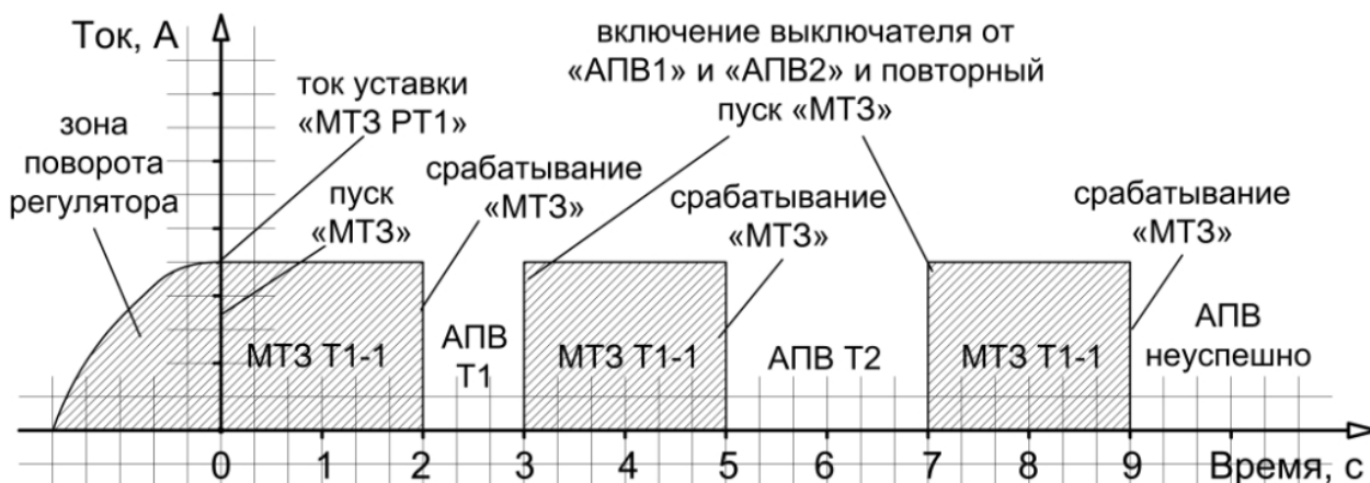
Рисунок 21 – Временной график работы МТЗ АПВ
