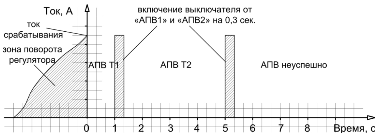
Рисунок 17 – Временной график работы ТО и АПВ
