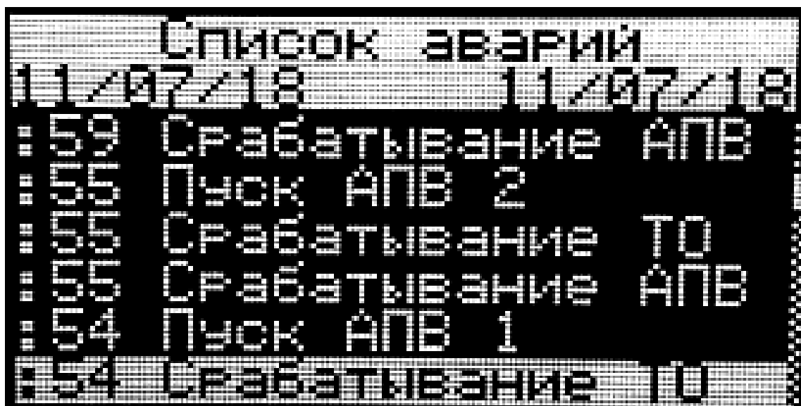
Рисунок 16 – «Список аварий» при срабатывании ТО
